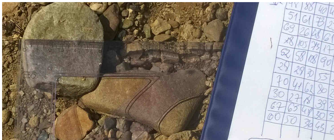
Pomiar średnicy "b" ziaren żwiru i kamieni koryta rzecznoego dopływu rzeki Bóbr przezroczystym przymiarem milimetrowym (ISO 9195:1992(E))
