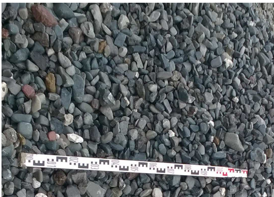
Przykładowe kruszywo naturalne rzeczne 16 \div 120 mm ze żwirowni w Radymnie k/Przemyśla (wstępne odsianie przez ruszt o rozstawie prętów 100 mm, a następnie przez sito #16 mm)
