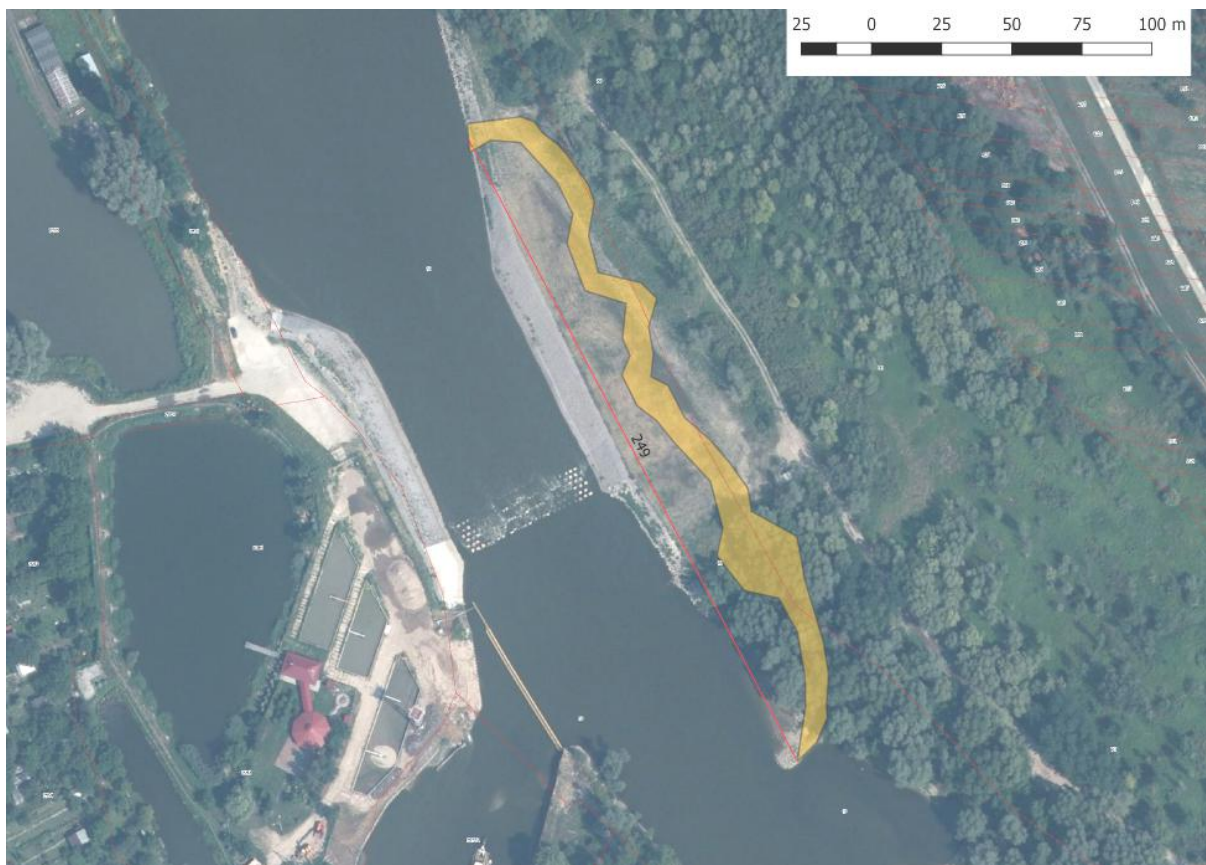
Rys. 18. Propozycja przebiegu obejścia bocznego. Szacowana długość objęcia bocznego 250-280 m.
